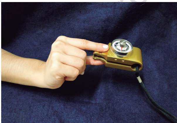
Figura 6 — Avaliação da força isométrica de pinça polpa a polpa por meio do dinamômetro pinch gauge. Fonte: Arquivo de imagens dos autores.
